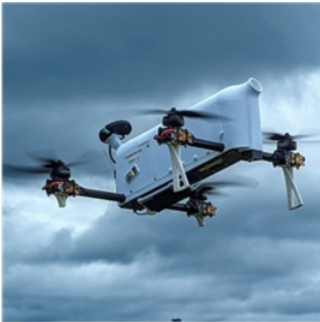
사진 4 NOAA에서 기상관측용 UAS로 개발된 CopterSonde-SWX-Q의 모습 (출처: https://inside.nssl.noaa.gov/uas/why-uas/ )
